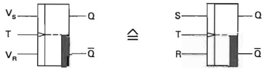
Fig. 6/40 - Memoria RS pilotata dinamicamente.
