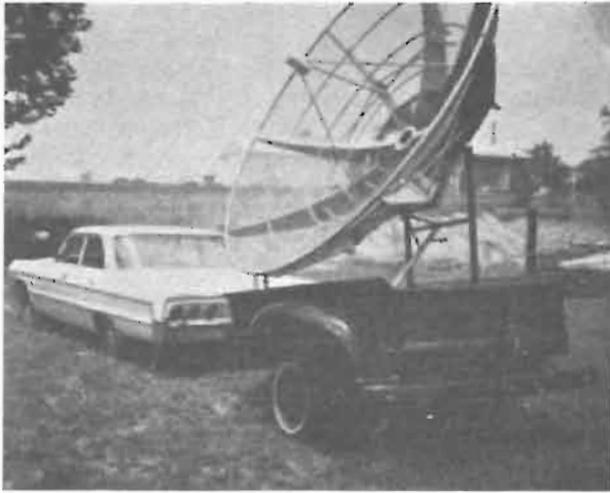
Fig. 5 - Un paraboloide di 3 m per le gamme 2,3 ed 1,2 GHz può essere anche autotrasportato.
